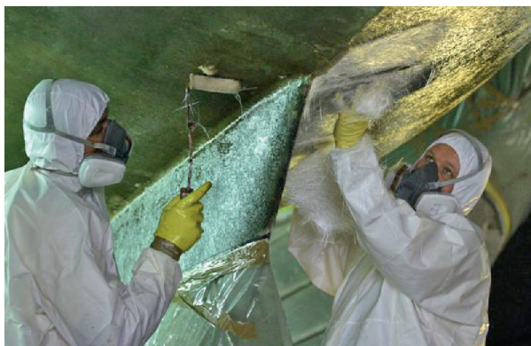
Die neue Schutzschicht wird auflaminiert.
