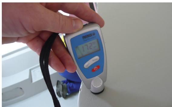
Qualitätssicherung durch Schichtstärken-Messung
