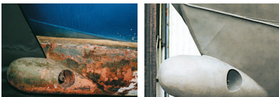
Korrodiertes Stahlrumpf vor / nach dem Strahlen
