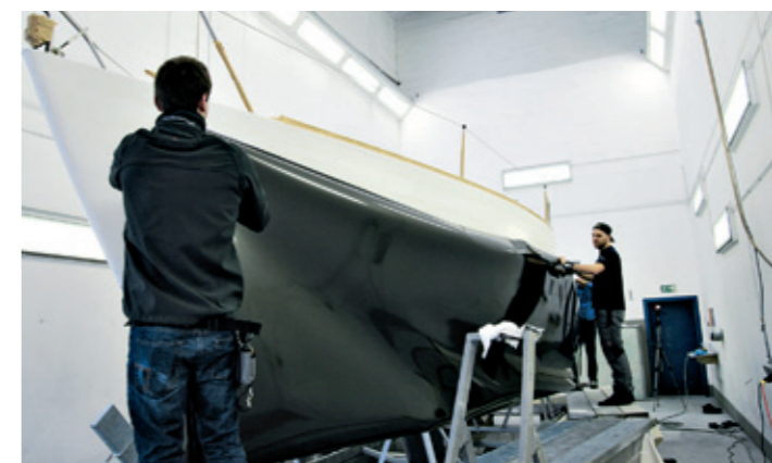
Die Folie wird immer großflächig verarbeitet und nicht in kleinen Stücken zusammengepuzzelt
