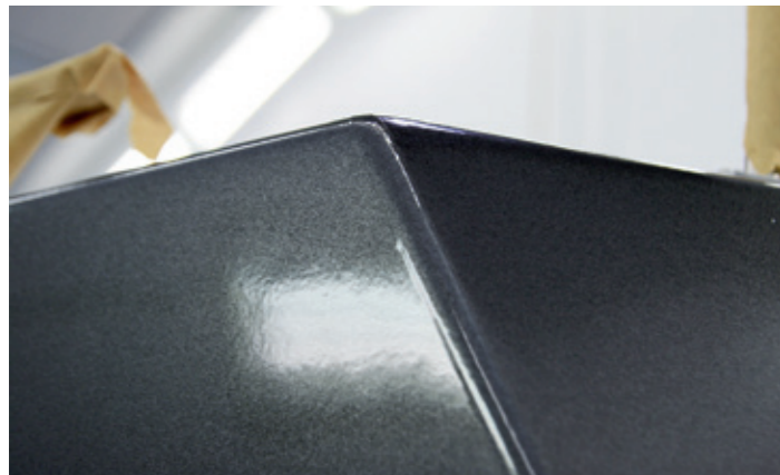
Die Schnittkanten der einzelnen Folienteile überlappen sich. Da die allerdings genau in der Lichtkante sitzen, lässt sich kaum erkennen, wo die eine Folie aufhört und die andere beginnt
