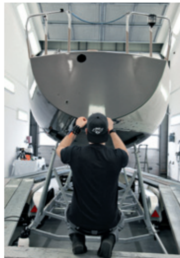
Die Schnittkanten der einzelnen Folienteile überlappen sich. Da die allerdings genau in der Lichtkante sitzen, lässt sich kaum erkennen, wo die eine Folie aufhört und die andere beginnt
