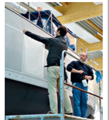
Fenderprotect-Folie schützt den Rumpf vor dem Fender-Abrieb
