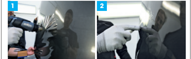
Rund um den Borddurchlass wird die Folie erwärmt (1) und mit dem Rakel in Richtung Durchlass glattgestrichen. Mit dem Cutter wird die Folie eingeschnitten (2).
