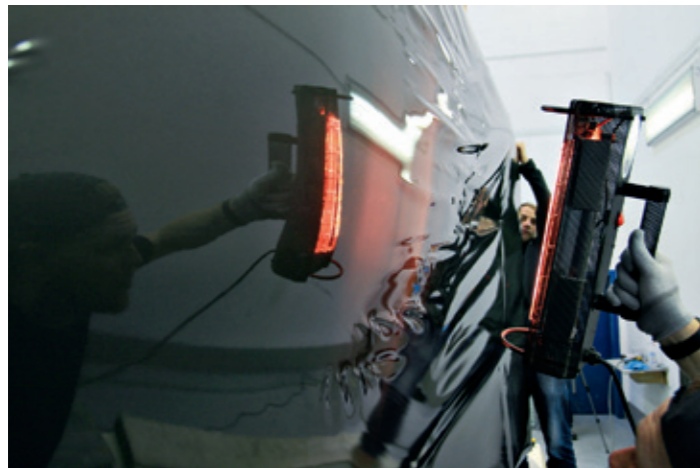
Damit sich die Folie den Rundungen des Rumpfes anpasst, wird sie im oberen Teil erwärmt und gedehnt. An der Deckskante muss mehr Strecke bedeckt werden als entlang des Wasserpasses
