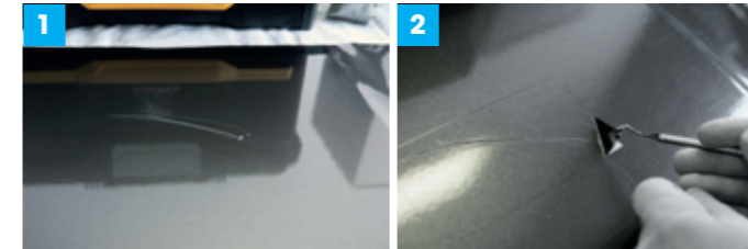
Bei Beschädigungen der Folie (1) lässt sie sich mit einem Patch reparieren. Mit dem Cutter wird der Bereich ausgeschnitten und entfernt (2).
