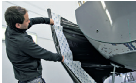
Damit sich die Folie den Rundungen des Rumpfes anpasst, wird sie im oberen Teil erwärmt und gedehnt. An der Deckskante muss mehr Strecke bedeckt werden als entlang des Wasserpasses
