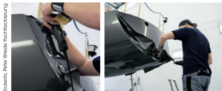
Ohne Wärme aus dem Heißluftföhn lassen sich die Kanten der Folie nicht bearbeiten und an den Rumpf anpassen
