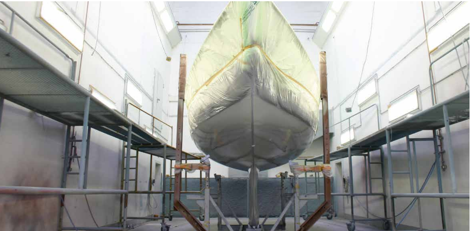
Bearbeitung der Schiffe in einer speziellen Rumpf-Stütztechnik
