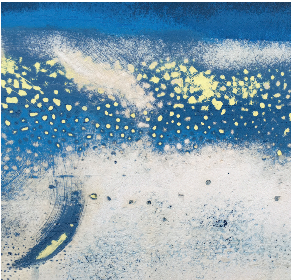
Ähnlich gut funktioniert eine Schleifprobe mit 120er Körnung, die erhabenen Blasen werden geköpft und sind so markiert.
