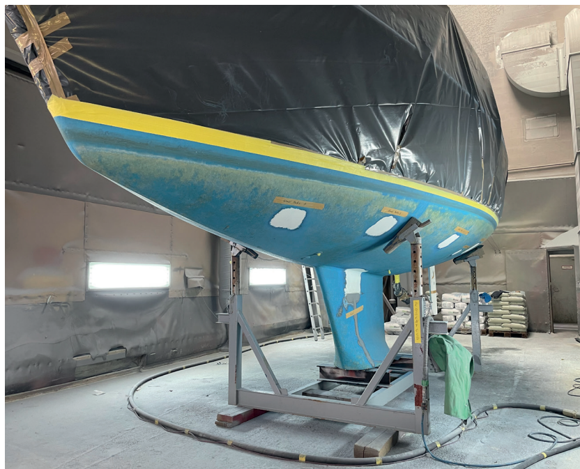
Strategisch verteilt wird die Oberfläche des Unterwasserschiffes an verschiedenen Stellen überprüft, auch Kiel und Ruder sowie das Laminat in der Nähe der Bockstützen sind kritische Bereiche.
