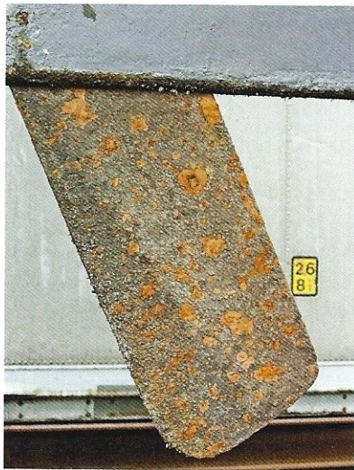
Starke Korrosion an einem Bleikiel-schwert.
