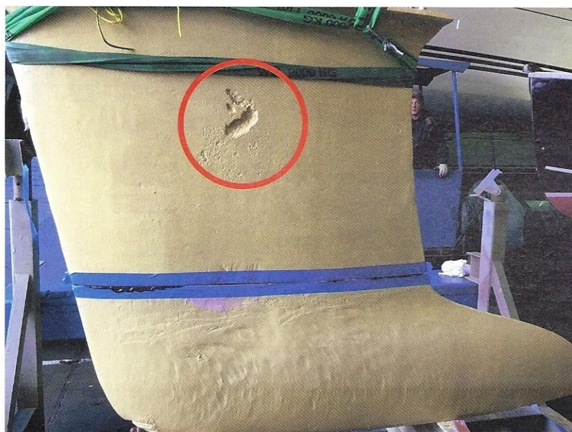
Gestrahlter Kiel mit Lunker (roter Kreis).
