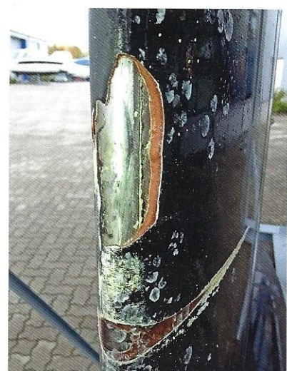
Durch die Schot verursachte Abplatzungen.
