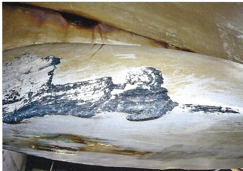
Grundberührungen hinterlassen an Bleikielen keine nennenswerten Schäden.
