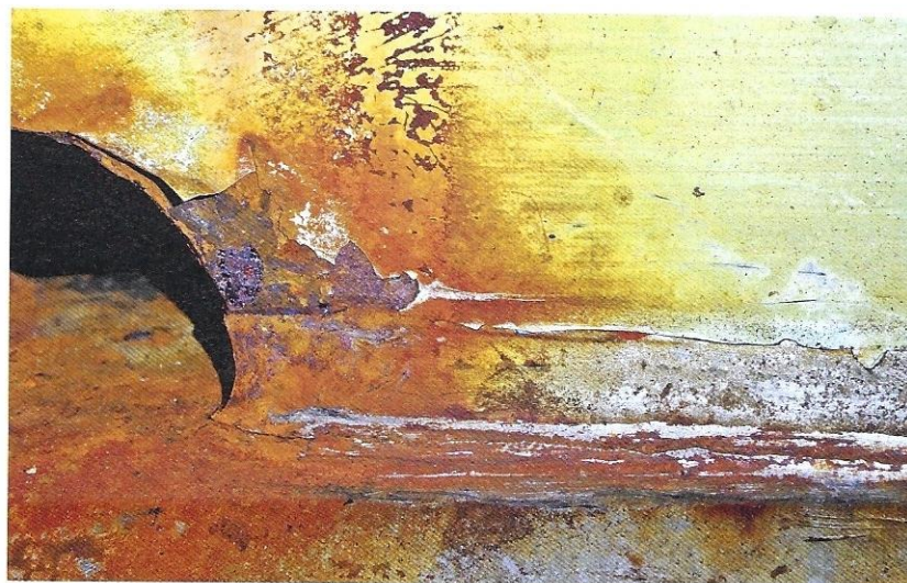
Stark korrodierter Kiel. Ohne Sanierung lebensgefährlich.
