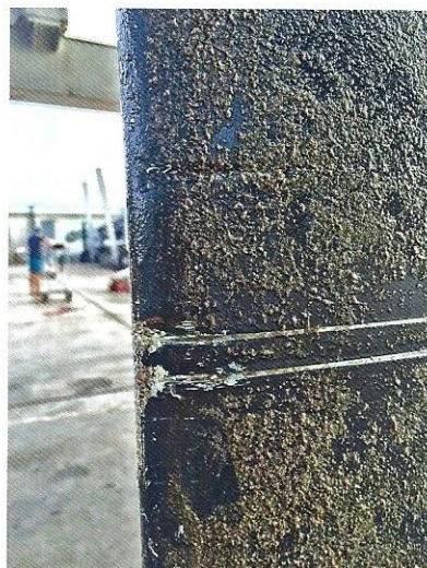
Schaden durch eine eingefressene Spinnaker-Schot.
