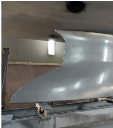
Anschließend erhält der Kiel eine Dickschicht-Epoxidbeschichtung im Airless-Spritzverfahren.
