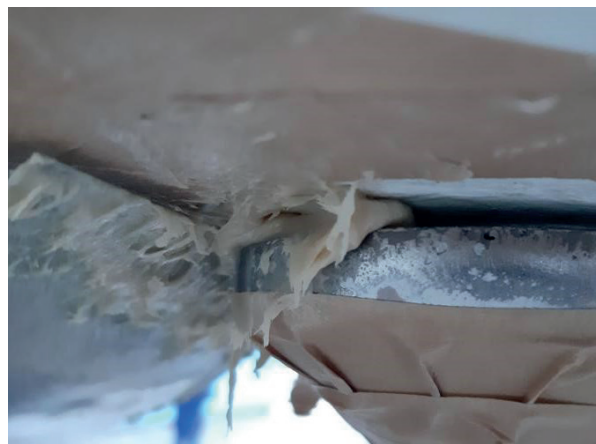
Bevor die Yacht wieder auf dem Kiel ruht, werden die Spalten mit Epoxidkleber verfüllt, so wird das Kielbett ausgeglichen und er Kiel sitzt wieder kraftschlüssig unter dem Rumpf.
