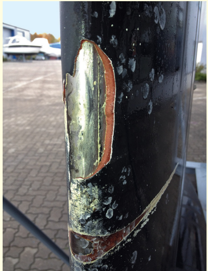
▲ Bei einem missglückten Spi-Manöver fraß sich die Dyneema-Schot bis aufs Metall durch
