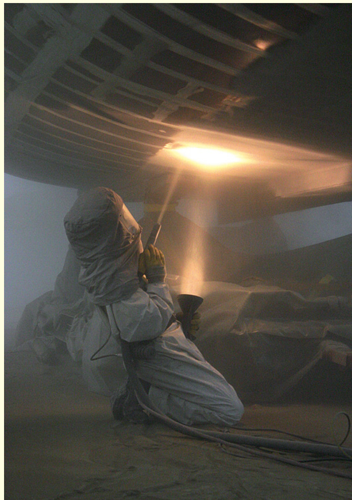
▲ Wehret den Anfängen! Denn wenn der Rost erst einen kritischen Grad erreicht hat, hilft nur noch Sandstrahlen
