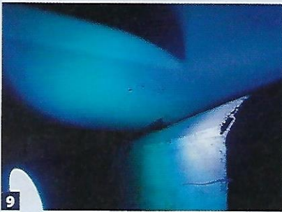
Lichtprüfung Schwarzarbeit: Das Unterwasserschiff wird nach dem Strahlen mit einer UV-Schwarzlicht-Lampe gründlich auf Osmose untersucht
