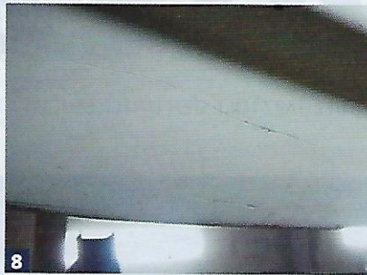
Schäden Das ständige Rauf und Runter: Auf- und Abslippen und die Reisen auf dem Trailer haben im Gelcoat und im Laminat deutliche Spuren hinterlassen
