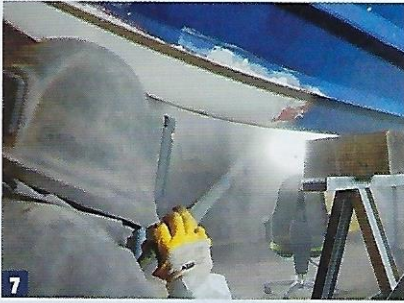
Strahlen Auf die sanfte Tour: Die kreisenden Bewegungen des Rotoblast lösen den alten Anstrich mühelos und (ver-)schonen dabei den Gelcoat
