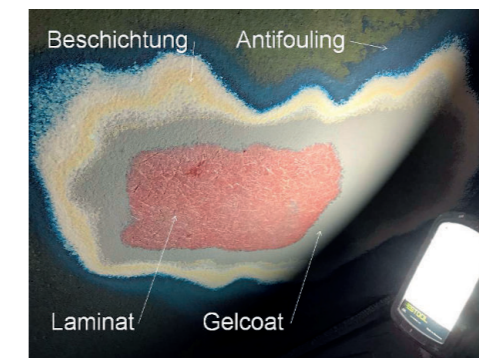
Die einzelnen Schichten eines Rumpfes vor dem Versiegeln
