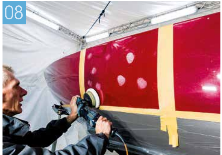
08 Wenn mit Medium-Politur begonnen wurde, werden die Schritte 1 bis 6 mit feiner Politur wiederholt.
