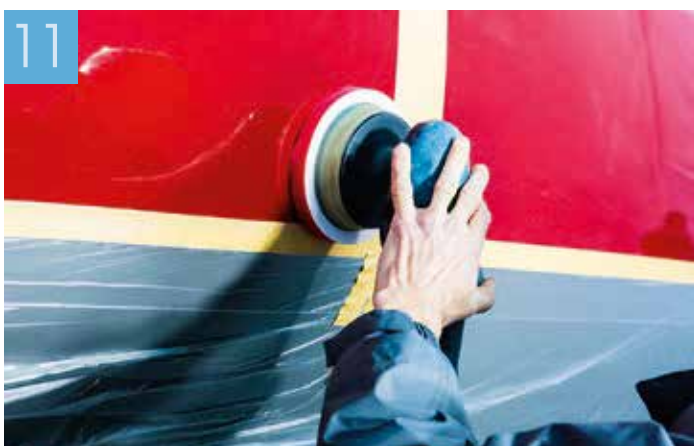
11 Eine Polymerversiegelung baut Schichtstärke auf, sodass sie die Oberfläche wie eine Glasscheibe schützt. Die Versiegelung fügt dem Glanz die Brillanz hinzu.
