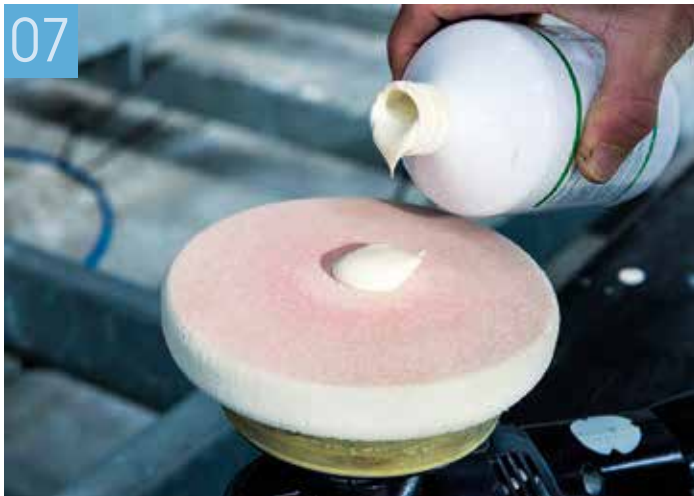
07 Der Farbstich im Pad zeigt den abrasiven Prozess: rotes Gelcoat wird abgetragen.
