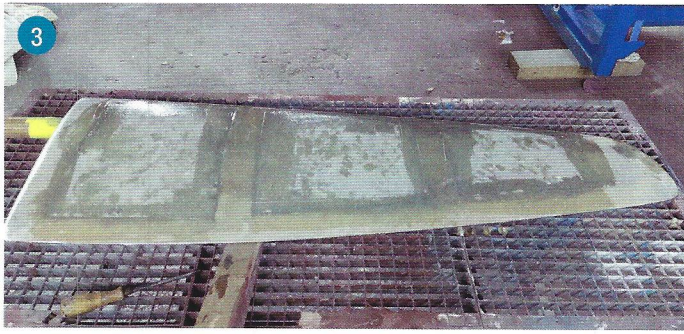
3. Ein sechslagiges Biaxialgelelaminat in Epoxidmatrix bildet die neue Außenhülle des Ruderblattes.
